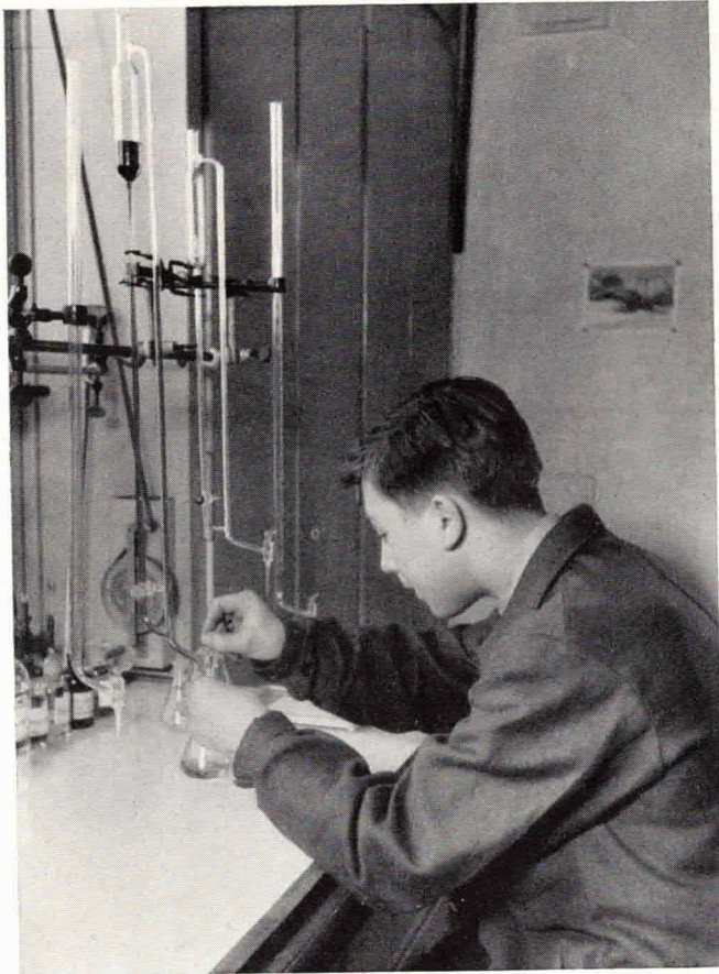
Der Laborant bedient eine Burette. Es ist dies ein in der analytischen Chemie vielverwendetes Gerät zum genauen Messen kleiner Flüssigkeitsmengen.
